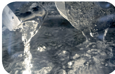
→ Sodium liquide dans l'installation FONTANA
